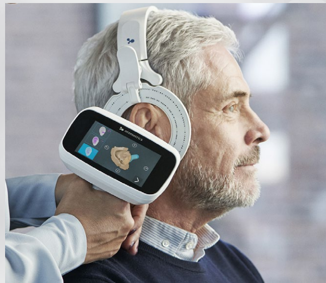
Die innovative Technologie verwandelt Bilder des Ohres in 3D-Dateien, die zur Herstellung eines exakt angepassten Hörsystems dienen.
